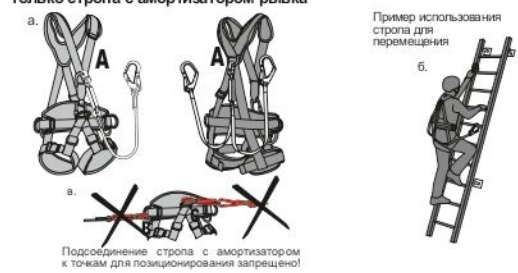
Рис. 5. В страховочных системах допускается использование только стропа с амортизатором рывка
