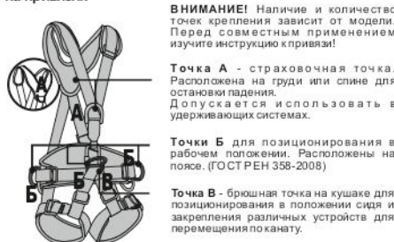
Рис. 4. Расположение и назначение крепежных точек на привязях
