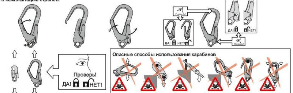
Рис. 6. Краткая пиктографическая информация по использованию карбинов, входящих в комплектацию стропов.
