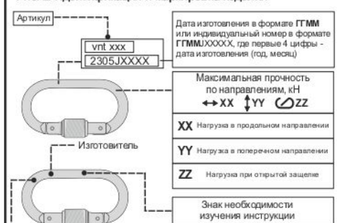
Рис. 2. Идентификация и маркировка изделия
